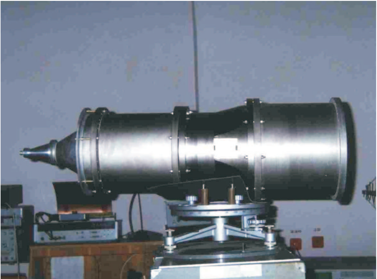
Рис. 5. Фотография блока коаксиального волноводно-секторного АФУ вместе с секцией согласования ЭДС генератора с магнитной изоляцией и конической системой ввода мощности, установленного на поворотном столе испытательного стенда
